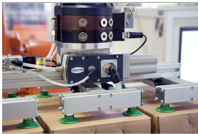
Génération du vide centralisée par éjecteurs basiques SBPL
